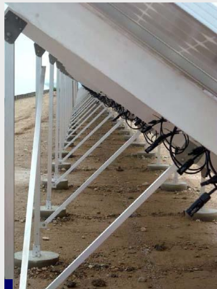
Detalle estructura SUN
