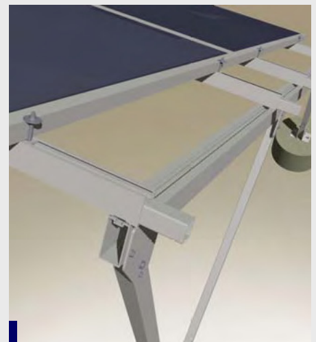
Detalle estructura SUN
